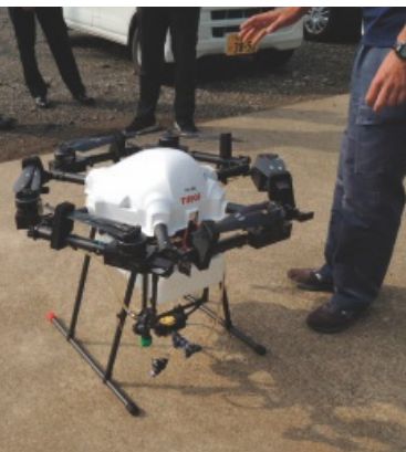
今回の実証で使用したドローン (液剤10L、粒剤9kg積載可能)
